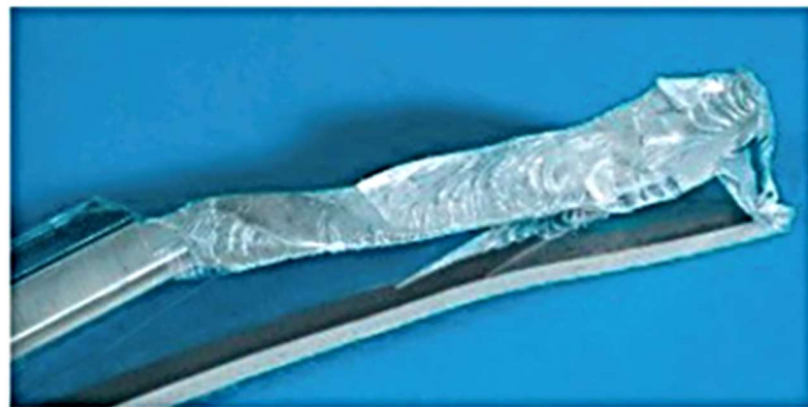
Bild 3.5 Durch hydrolytischen Abbau versprödetes Formteil aus PC (TI Bayer Material Science, 2008)
